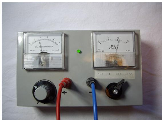
**Fig. 1** Prototipo de galvanizador analógico que mide simultáneamente la intensidad y el voltaje aplicados durante la sesión. Los parámetros cambian en tiempo real de acuerdo al comportamiento del circuito.
